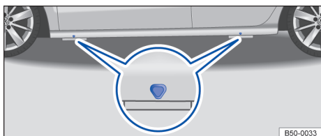
Fig. 201 Pontos de apoio do macaco.
