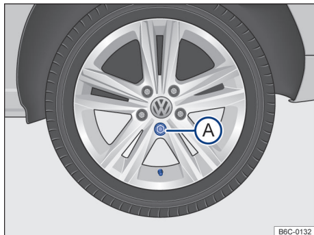
Fig. 199 Retirar a calota integral.
