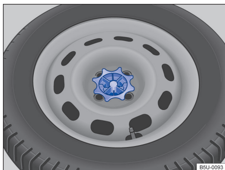
Fig. 197 No compartimento de bagagem: manípulo para fixação da roda de emergência.
