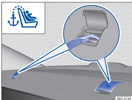
Fig. 43 Olhal de retenção para o cinto de fixação superior na cobertura do compartimento de bagagem.
