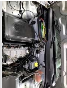
PAINEL CORTA FOGO
