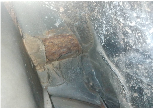
Corrosão acentuada por trás da torre do amortecedor dianteira direita
