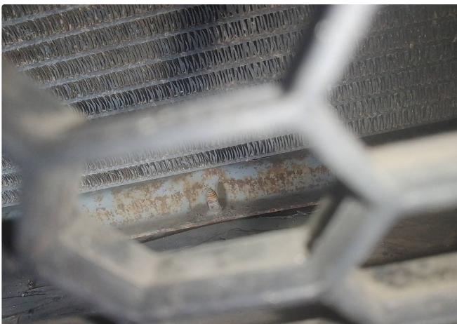
Painel dianteiro inferior com corrosão inicial
