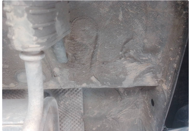
Caixa de ar lado direito com corrosão inicial e recuperada com massa
