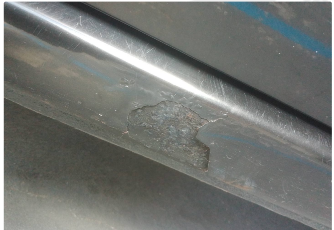
Caixa de ar lado direito com corrosão inicial e recuperada com massa
