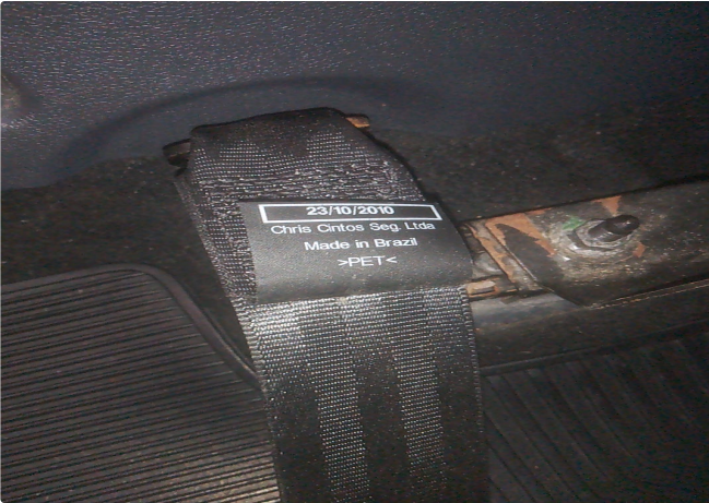
Assoalho da mala parte interna com corrosão inicial lado direito
