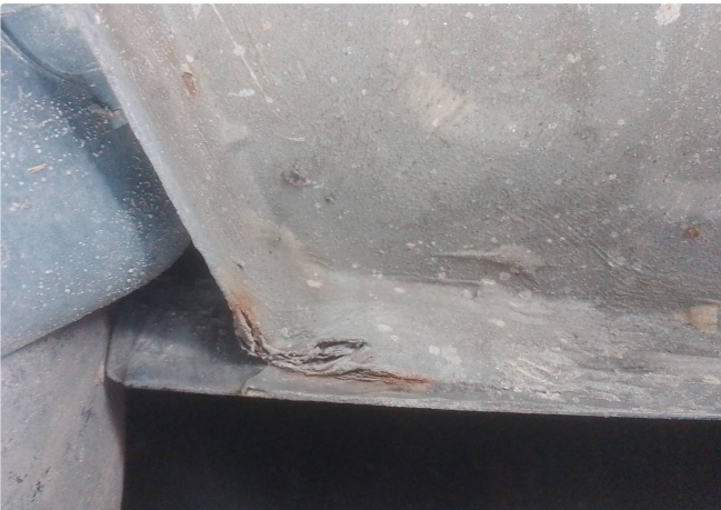
Assoalho da mala parte interna com corrosão inicial lado direito
