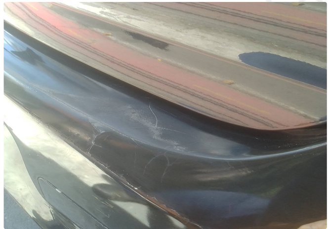
Para choque traseiro recuperado com massa
