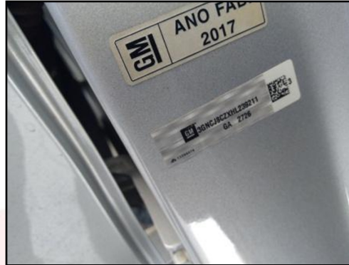
FOTO ETA COLUNA
